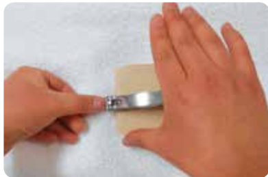
カッティングシートで包装した板に爪切りを固定しています
